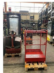
Arbeitskorb für 2 Personen maximale Tragkraft 240 kg. Der Arbeitskorb ist TÜV geprüft und entspricht den Unfallverhütungsvorschriften (UVV)
